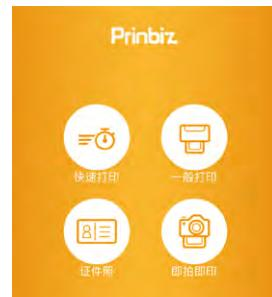
打开Prinbiz 应用程式进行打印。在快速打印和一般打印之间进行选择，一般打印模式可让您在打印前编辑照片并调整照片大小，而快速打印模式则在您选择照片后立即打印。
