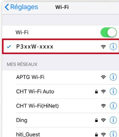
Allumez l'imprimante et allez à la page «Paramètres WiFi» de votre appareil mobile pour trouver «P3xxW-xxxx». Appuyez sur le nom de l'appareil pour vous connecter à l'imprimante.
