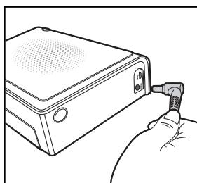
2. 將電源變壓器插入印相機，然後將電源線插入電源插座。
