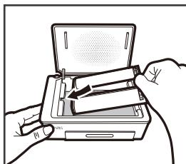
3. Siga la dirección de la flecha marcada en la cinta de tinta y dentro de la impresora, y luego deslice la cinta de tinta en el compartimiento vacío.
