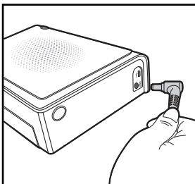
2. 将电源变压器插入印相机，然后将电源线插入电源插座。
