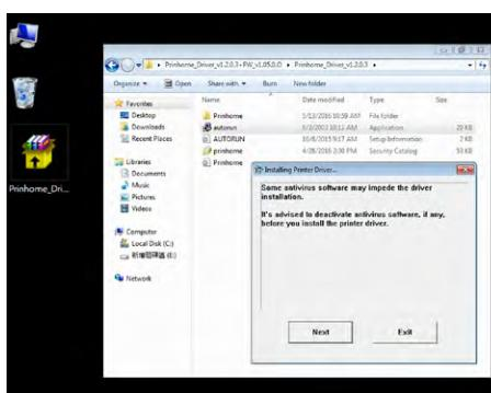
Una vez que se completa la descarga, debe extraer los archivos y hacer click para ejecutar el programa AUTORUN.exe y completar la instalación.
