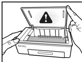
2. Soulever le volet du ruban. La tête d'impression doit chauffer pour réaliser correctement les fonctions attendues du produit.
