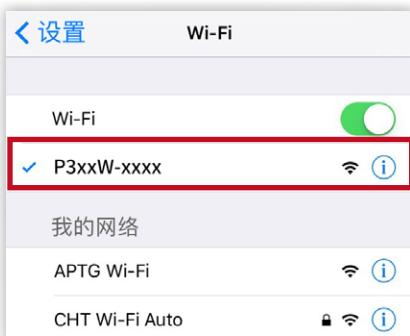
打开打印机并到无线设备上的 WiFi 设置页面查
