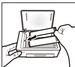
3. Suivez les flèches indiquées sur le ruban encreur et à l'intérieur de l'imprimante, puis faites-le glisser dans le compartiment vide.
